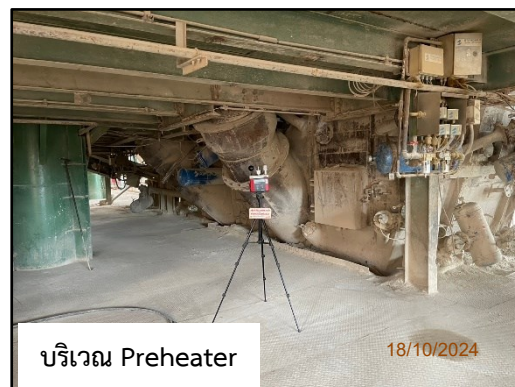
ภาพที่ 3.149 การตรวจวัดความร้อนในสถานที่ทำงานบริเวณหม้อเผา 6 และ บริเวณ Preheater
