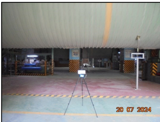
ภาพที่ 3.103 การตรวจวัดฝุ่นในสถานที่ทำงาน บริเวณหม้ออบซีเมนต์ 10
