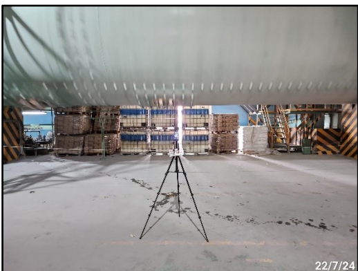
ภาพที่ 3.131 การตรวจวัดระดับเสียงบริเวณ เครื่องจักรบริเวณหม้อบดซีเมนต์ 5
