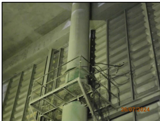
ภาพที่ 3.5 การตรวจวัดคุณภาพอากาศจาก ปล่องหม้อบดซีเมนต์ 5
