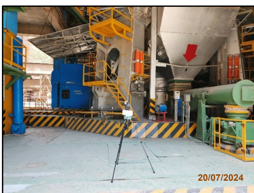
ภาพที่ 3.97 การตรวจวัดฝุ่นในสถานที่ทำงาน บริเวณหม้อบดวัตถุดิบ 6
