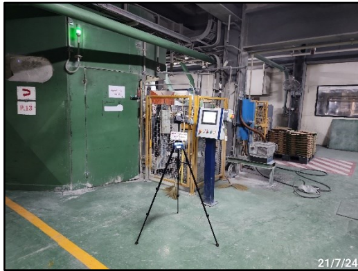
ภาพที่ 3.89 การตรวจวัดฝุ่นในสถานที่ทำงาน บริเวณแผนกบรรจุปูนซีเมนต์ 13
