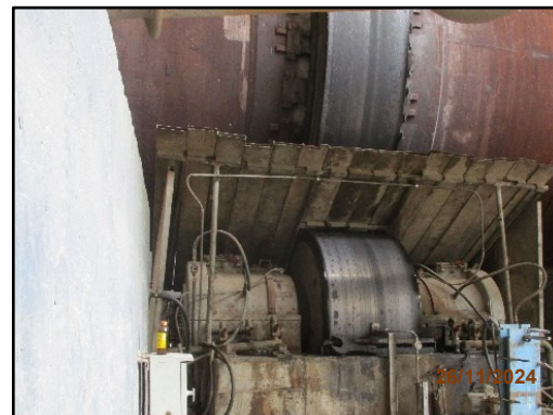
ภาพที่ 2.62 สภาพฉากป้องกันความร้อนระหว่าง Preheater กับคณงานและติดตั้งกรงเหล็ก
