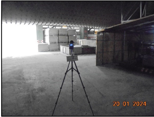
ภาพที่ 3.133 การตรวจวัดระดับเสียงบริเวณ เครื่องจักรบริเวณหม้อบดซีเมนต์ 7
