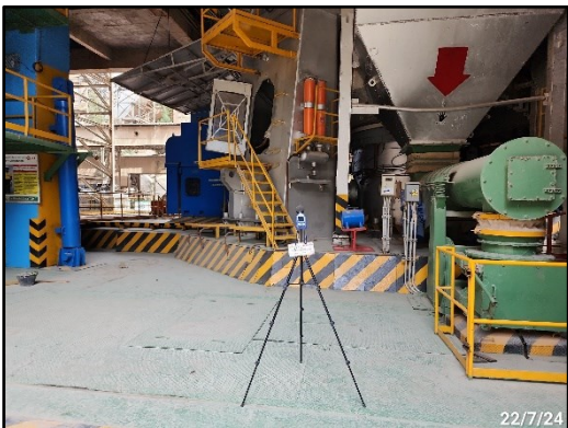
ภาพที่ 3.129 การตรวจวัดระดับเสียงบริเวณ เครื่องจักรบริเวณหม้อบดวัตถุดิบ 5
