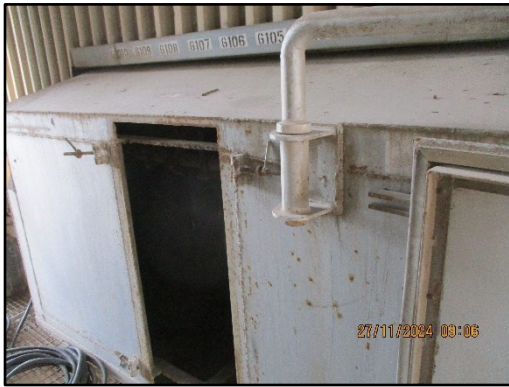
ภาพที่ 2.27 Casing รั่วซึมชุด Hammering Equipment
