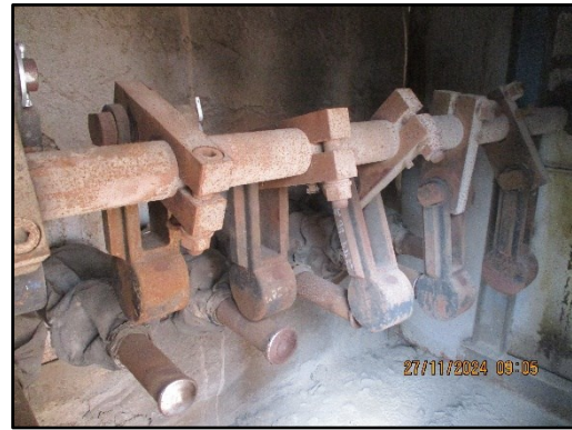
ภาพที่ 2.27 Casing รั่วซึมชุด Hammering Equipment
