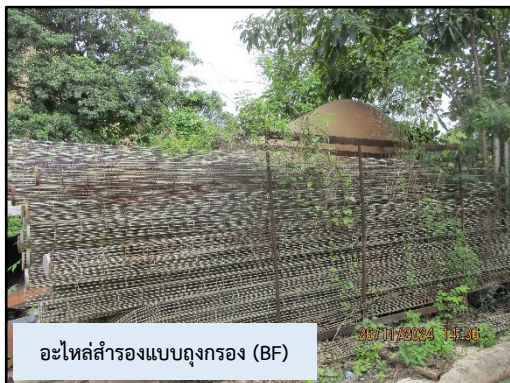
ภาพที่ 2.4 Stock อุปกรณ์/อะไหล่สํารองของระบบบำบัดมลพิษอากาศ
